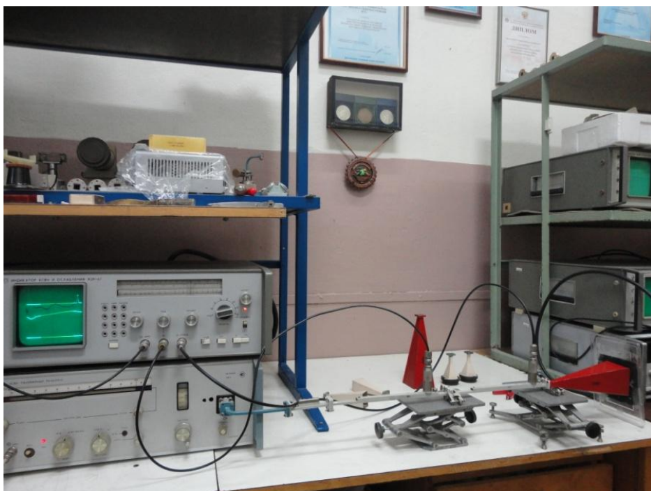
Рис. 4. Фотографии схемы измерения коэффициента отражения УНМ антенным методом в диапазоне частот 26–37.5 ГГц
