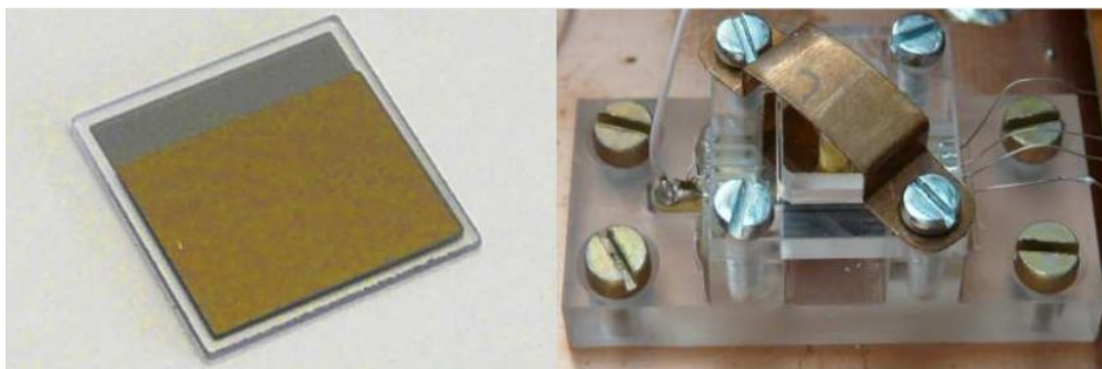
Рис. 2. Слева – пластина синтетического сапфира с металлизацией. Справа – детекторная сборка из 8 сапфировых пластин
