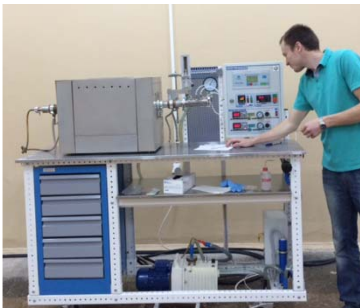
Рис. 3. Старший научный сотрудник Дмитрий Быченко возле установки по CVD синтезу многостенных углеродных нанотрубок
