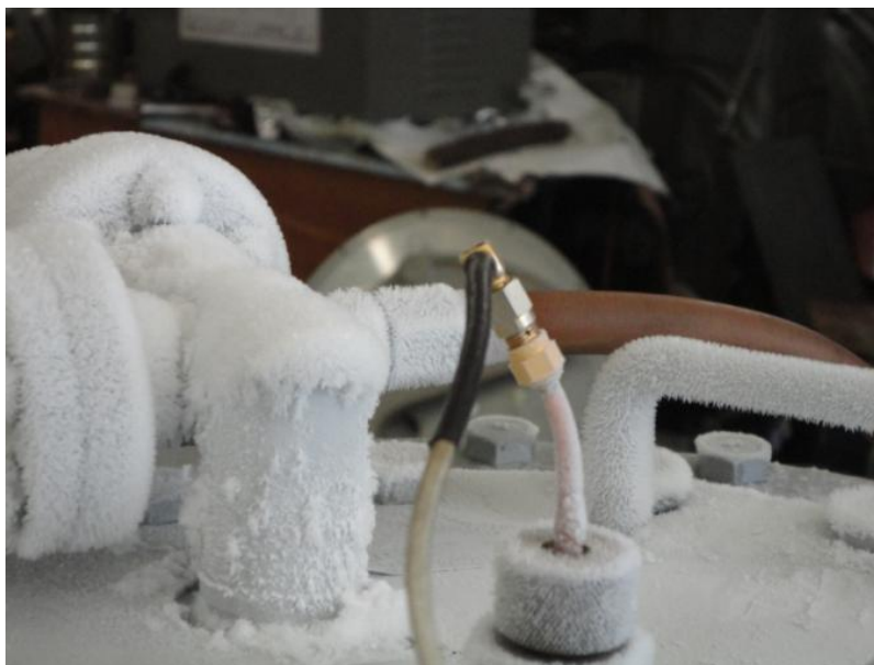
Рис. 4. Фотография верхней крышки криостата с выходным разъемом СВЧ кабеля
