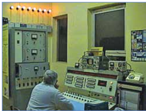
Ускоритель электронов УЭЛВ –10-10. Пультовое управление
