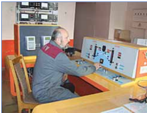
Гамма-установка УГУ–420. Пультовое управление
