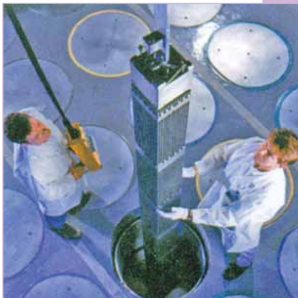
Загрузка ТВС в реакторы
