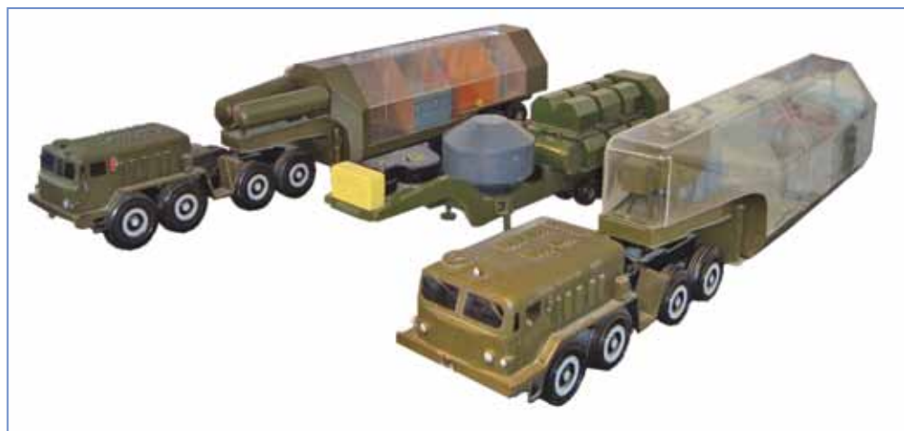
Макет передвижной атомной электростанции ПАЭС «Памир-630Д»
