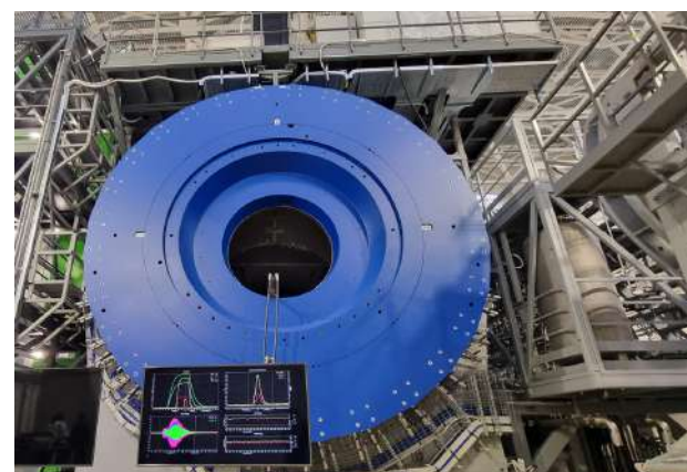
Сістэма ахалоджвання электронікі і тэрмастабілізацыі працоўнага аб'ёму газу ў эксперыментах NICA-MPD
