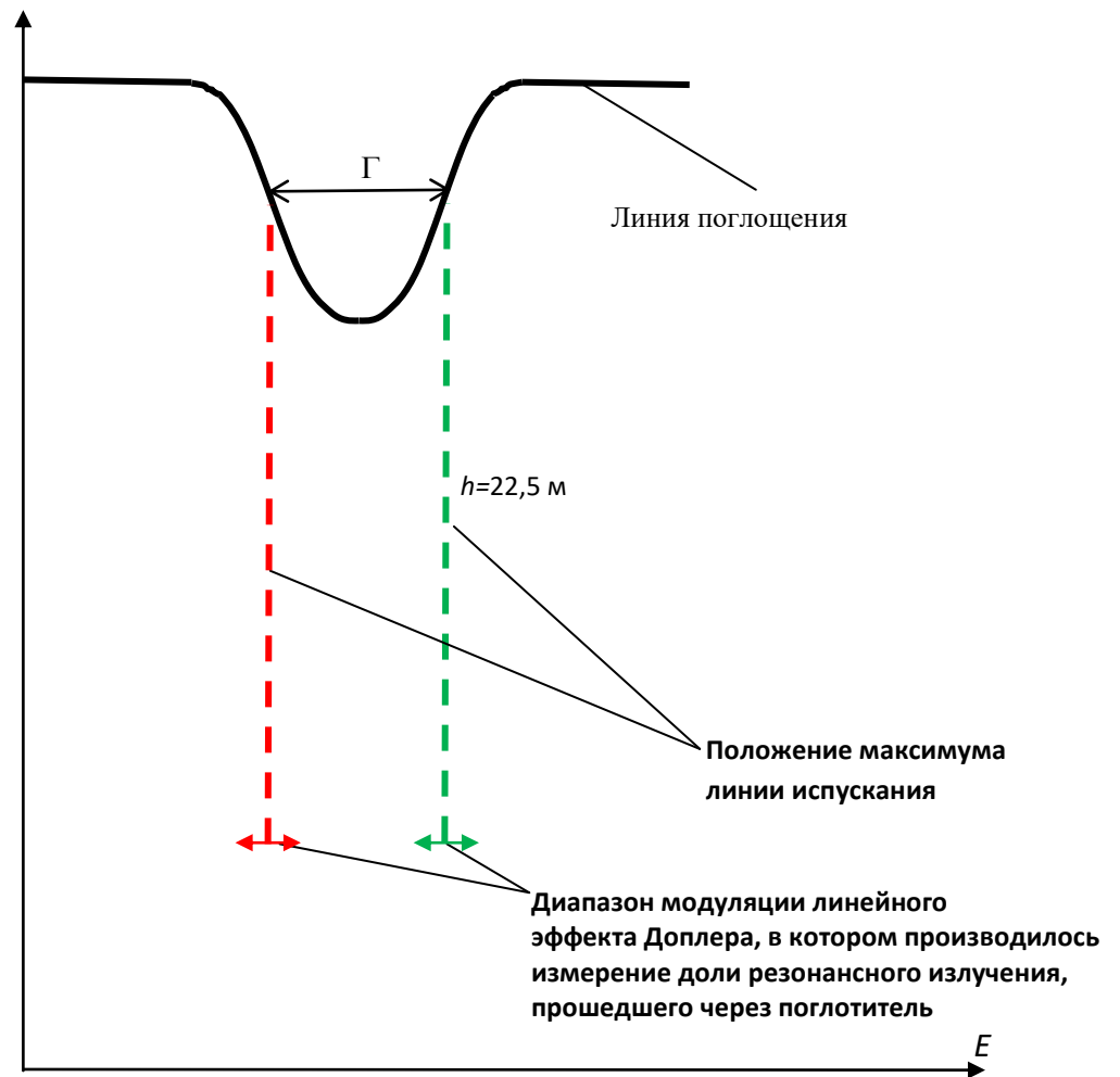
Рис. 5.17. К иллюстрации алгоритма измерения относительного энергетического сдвига линий испускания и поглощения, использованного к эксперименте Паунда и Ребки. При однородном смещении обеих пунктирных линий вдоль оси энергии гамма-квантов E , изменение степени поглощения резонансных гамма-квантов на обоих склонах резонансной линии имеет противоположные знаки
