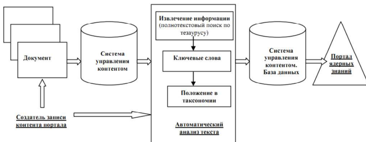
Рисунок 4. Семантический алгоритм размещения информационного ресурса на Национальном портале для автоматического формирования ключевых слов и предложения разделов портала для опубликования материала
