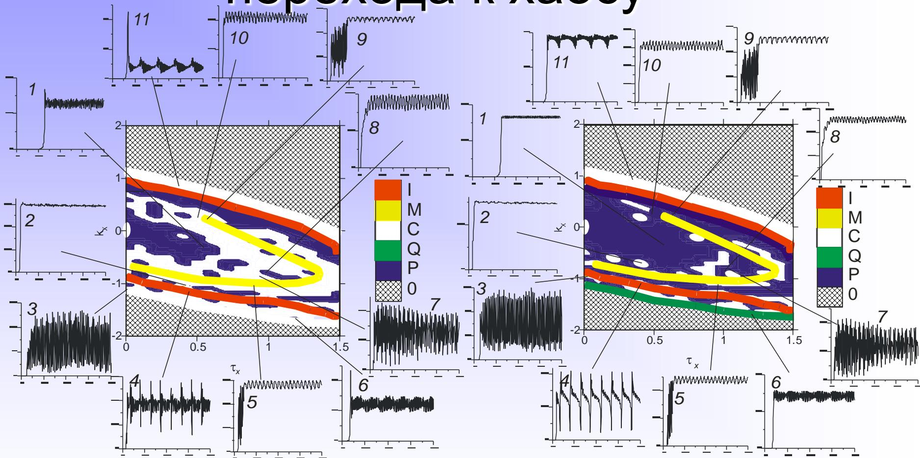
0 означает, что плотность тока находится ниже порога. P – периодические режимы, Q – квазипериодичность, C – хаос, I – перемежаемость, M – переход между высокоамплитудными и низкоамплитудными режимами. По краям приведены зависимости амплитуды  $|E(L, t)|$  от времени (в нс)
