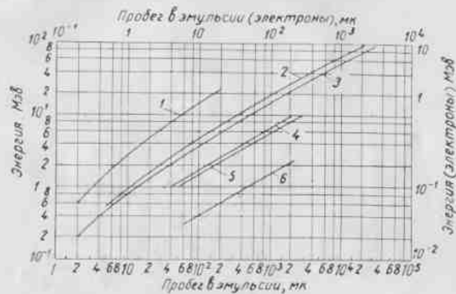
Рис. П. 22. Зависимость пробега различных частиц в фотозумульсии от энергии (см. [127], гл. II):
