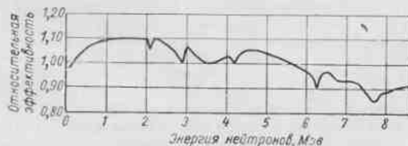
Рис. III.12. Относительная эффективность длинного счетчика в зависимости от энергии нейтронов. Кривая составлена на основании результатов, полученных в Харуэлле (0,02—2 Мэв) и в Лос-Аламосе (выше 1 Мэв), данные перекрываются в плоской части кривой от 1 до 2 Мэв.
