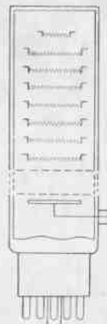
Рис. II. 20. Схема расположения диодов в фотоумножителе с продольной электростатической фокусировкой.
