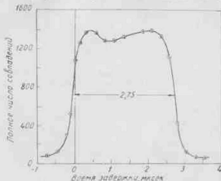
Рис. II. 18. Зависимость числа совпадений между импульсами борного счетчика и импульсами, вызываемыми \gamma -лучами в сцинтилляционном счетчике, от времени задержки.
