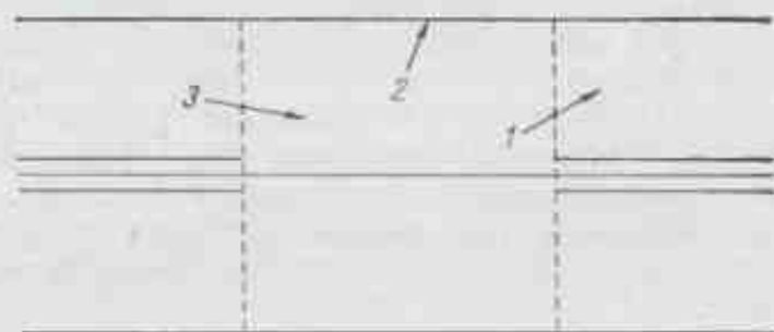
Рис. III. 4. Краевые эффекты в газонаполненном пропорциональном счетчике.
