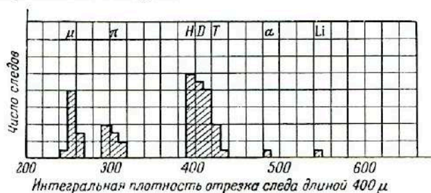
Рис. 1. Гистограмма значений интегральной плотности отрезка следа длиной 400 м для 55 следов в эмульсии Ильфорд G5.
