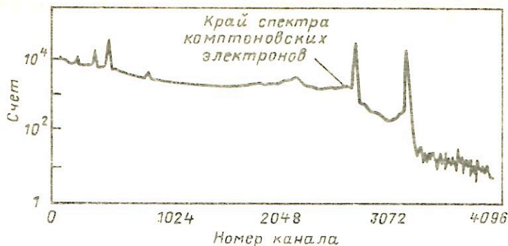
Рис. 10.1. Типичный линейчатый спектр \gamma -квантов
