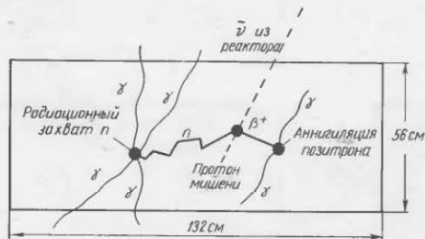
Рис. 5.3. Схема действия большого жидкого сцинтилляционного детектора антинейтрино.
