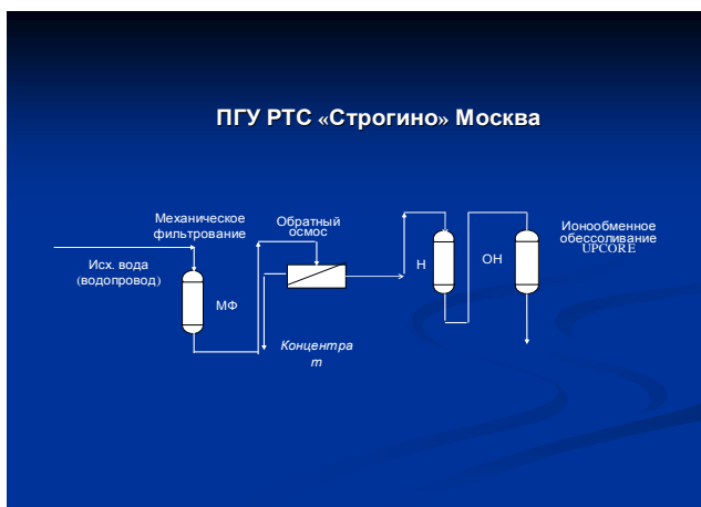
Рисунок 7. Принципиальная технологическая схема ВПУ на ПГУ РТС «Строгино»
