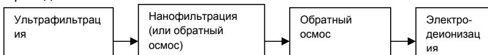
Рисунок 5. Принципиальная технологическая схема обессоливания воды до остаточной электропроводимости не более 0,1 мкСм/см с использованием ИМТ
