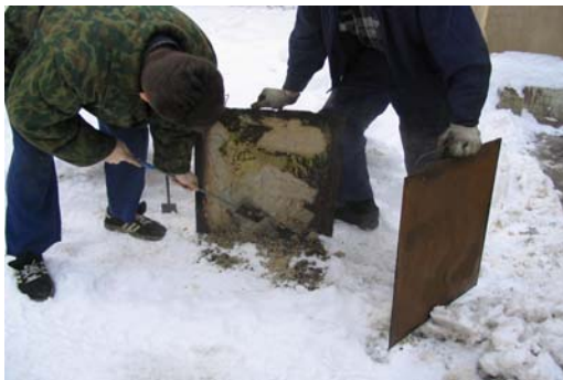
Рисунок 7. Чистка электродных кассет от уловленных солей накипи
