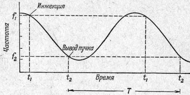
Фиг. 15. Модуляция частоты высокочастотной системы с помощью вращающегося конденсатора в пределах от начальной частоты f_1 до конечной частоты f_2 .
