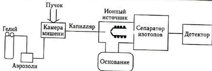
Рис. 13. Схема установки, в которой скомбинированы газовая струя и ионный источник (ISOL) [24]
