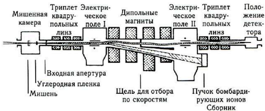
Рис. 17. Схематический разрез установки SHIP. Продукты реакции (верхний пучок) отделяются от бомбардирующих ядер (нижний пучок) и фокусируются на детектор [29]
