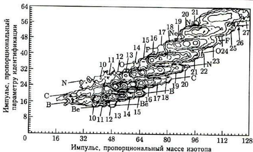
Рис. 1.5. Контурная карта выхода изотопов элементов от Be до Na, иллюстрирующая изотопное разрешение, достигнутое в \Delta E - E -методе с использованием двух полупроводниковых \Delta E -детекторов и ИВП; цифры указывают массовые числа изотопов [16]
