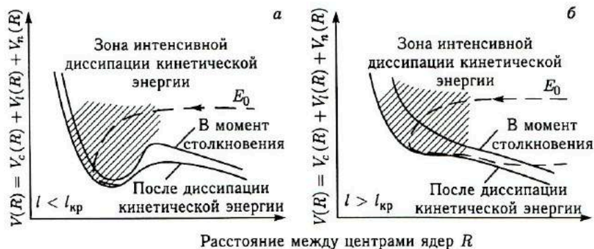
Рис. 3.4. Процесс взаимодействия двух сложных ядер в условиях интенсивного ядерного трения: а) с угловым моментом, меньшим критического: l < l_{кр} , б) с угловым моментом, большим критического: l > l_{кр}
