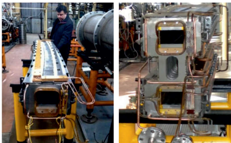
Рис. 7.26. Изогнутый дипольный магнит бустера (слева) и дипольный двухкамерный магнит коллайдера (справа). Сверхпроводящие магниты изготовлены по нуклотронному типу
