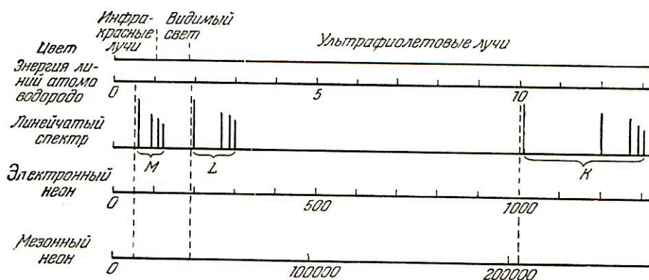
Рис. 6.1. Сравнение энергетических спектров электронного и мезонного атомов. Три верхние полосы показывают расположение водородных линий по отношению к видимому свету (верхняя полоса) и к энергетическому спектру водорода (вторая полоса). Линии испускания электронного неона должны быть на этом рисунке изображены в масштабе, измененном в 100 раз. Поскольку \mu -мезон в 210 раз тяжелее электрона, масштаб энергетического спектра мезонного неона должен быть изменен в 210 раз по сравнению с электронным неонам или в 21000 раз по сравнению с водородом.
