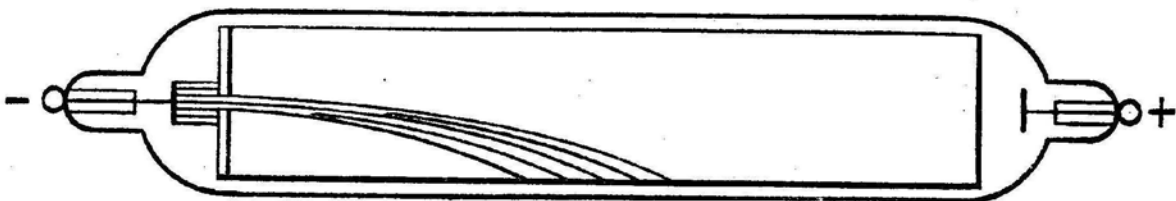
Рис. 16. Отклонение катодных лучей под действием магнитного поля
