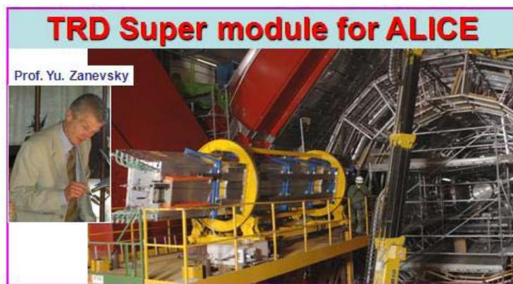
В конце прошлого года был создан первый супермодуль TRD детектора установки ALICE на основе камер, изготовленных сектором Ю.В. Заневского.
