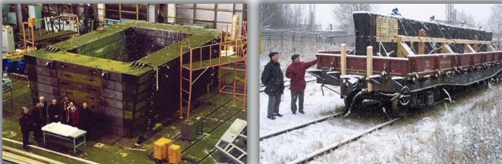
Ярмо мюонного магнита установки АЛИСА, изготовленное на Савеловском машиностроительном заводе (слева), и отправка деталей железного ярма мюонного магнита установки АЛИСА в ЦЕРН (справа)
