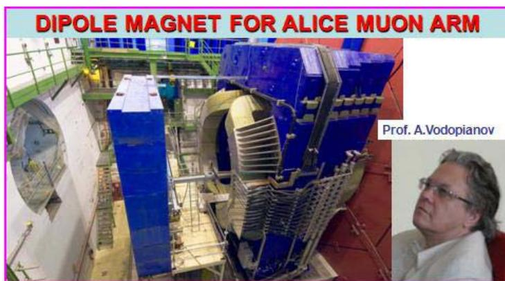
Для эксперимента ALICE на LHC изготовлено ядро большого дипольного магнита для мюонного плеча под руководством А.С. Водопьянова.
