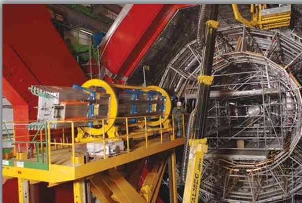
**Супермодуль детектора переходного излучения установки АЛИСА, изготовленного на основе камер производства сектора Ю.В. Заневского**
