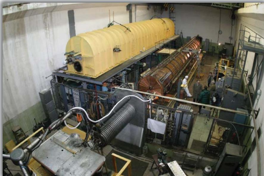
**ЛУ-20 со снятым вакуумным кожухом. Узлы уплотнения масляного охлаждения квадрупольных линз, находящиеся внутри трубок дрейфа (52 шт.), были переделаны**
