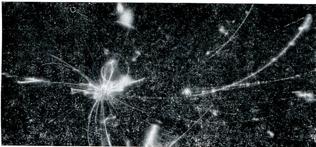
Рис. 9. Столкновение ядра неона с энергией 90 ГэВ с ядром неона газа стримерной камеры.
