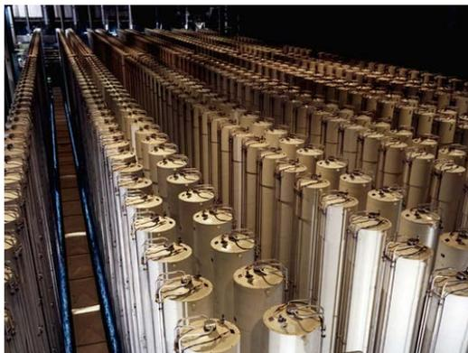
**Рис. 8.** Каскад центрифуг для обогащения урана
