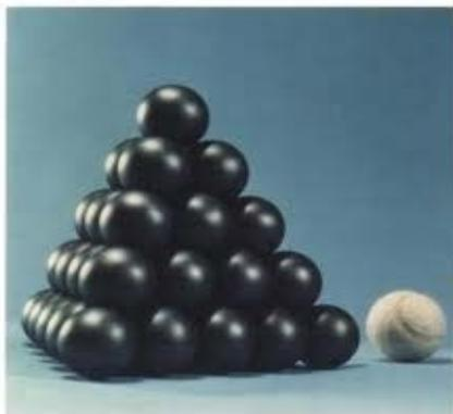
**Рис. 22.** Топливо PBMR-реактора
