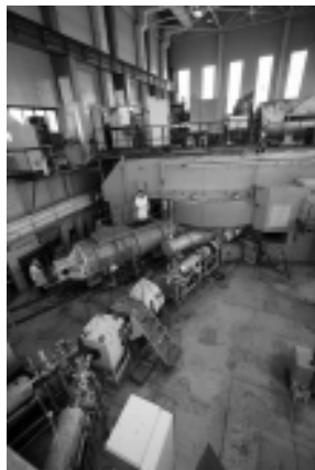
Рис. 5. Ускоритель тяжёлых ионов, используемый для синтеза изотопов новых элементов.
