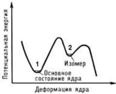
Рис. 25. Форма потенциального барьера при спонтанном делении ядра из изомерного состояния.
