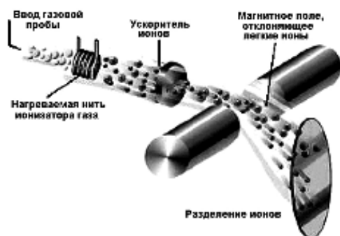
Рис. 10. Принцип работы масс-спектрометра.
