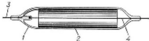
Рис. 7. Стеклянный счётчик Гейгера-Мюллера: 1 — запаянная стеклянная трубка; 2 — катод (тонкий слой меди на трубке из нержавеющей стали); 3 — вывод катода; 4 — анод (тонкая натянута нить).
