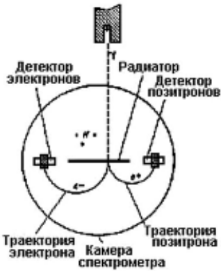
Рис. 14. Схематическое изображение парного гамма-спектрометра. В однородном магнитном поле H , направленном перпендикулярно плоскости чертежа, электроны и позитроны движутся по окружностям в противоположных направлениях.
