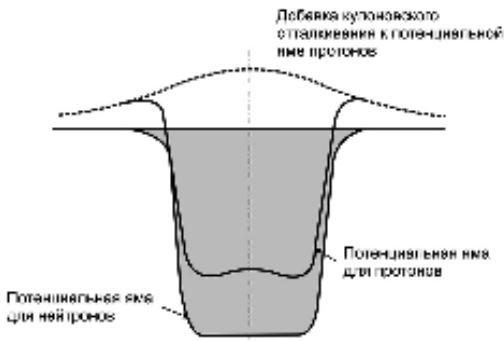
Рис. 5. Потенциальные ямы для протонов и нейтронов в атомном ядре.
