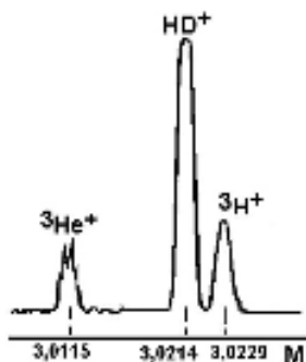
Рис. 11. Масс-спектр высокого разрешения – триплет масс с массовым числом 3.
