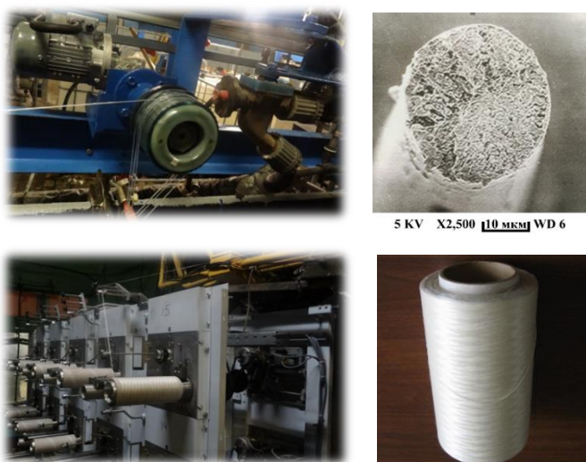
Рисунок 4. – Опытная установка получения самозатухающего целлюлозно-хитозанового волокна состава целлюлоза : хитозан = 80 : 20 и поперечный срез элементарного волокна
