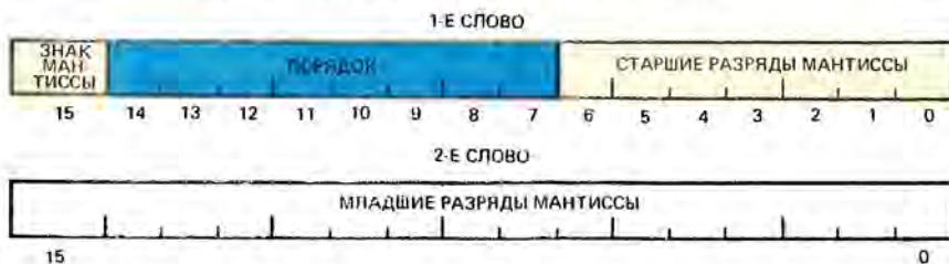
Рис. 3.13. В шестнадцатиразрядных ЭВМ числа с плавающей запятой представляются в виде двух машинных слов.
