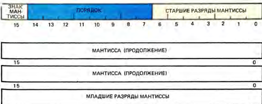
Рис. 3.15. Числа с плавающей запятой удвоенной точности записываются четырьмя машинными словами.
