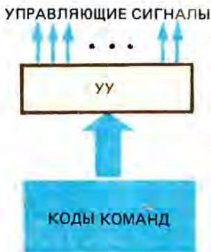
Рис. 2.3. ЦА, использующие принцип программного управления, не могут работать без символической (закодированной) программы, записанной в явном виде на каком-либо носителе информации.
