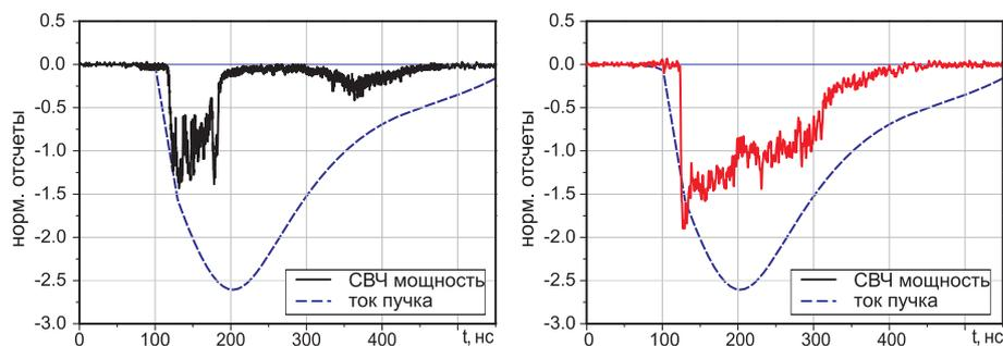
**Рисунок 4. – Сравнение зарегистрированных в экспериментах мощности СВЧ излучения для одного фотонного кристалла (слева) и мощности СВЧ излучения для двух последовательно расположенных фотонных кристаллов с разным периодом (справа), полученных при подаче одинаковых импульсов тока в сильноточном диоде**
