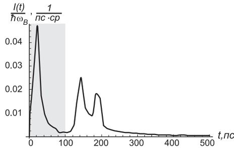
**Рисунок 2.** – Зависимость интенсивности квазичеренковского параметрического излучения от времени для терагерцового диапазона в случае двухволновой дифракции излучения в фотонном кристалле. Серым фоном отмечен период времени, когда частица находится в кристалле
