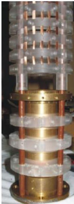
Фольговый резонатор – отрезок волновода с периодически натянутыми металлическими лентами со следующими параметрами:
